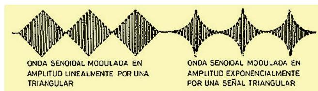
Fig. 4.38 Efecto gráfico. Respuesta de un VCA en modo lineal y exponencial.
