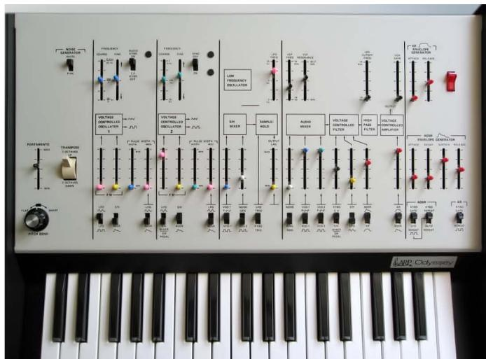
sicos controles potenciométricos rotativos por los del tipo deslizantes rectos, junto a botones de mando, de colores, que permiten una rápida inspección visual de un ajuste determinado, lo cual es de especial interés y utilidad bajo las malas condiciones de iluminación que suelen acompañar las actuaciones.
