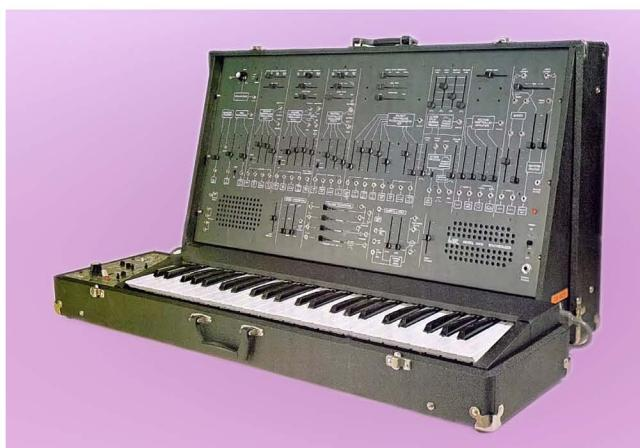
Fig. 6.13 El ARP 2600 en versión MKI, popularmente conocido como el ARP gris. Su Low Pass Filter era copia de la Red en Escalera de Moog y estaba encapsulado con la referencia 4012 para disimular, como en el ODYSSEY.
